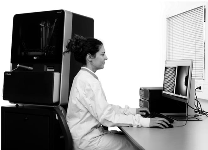
クライオ電顕用の凍結試料作製プロセスを、一つの装置に統合して完全自動化した画期的なシステムです。そこには、サンプル成膜と急速凍結に関する特許を含む高度な技術が集約されています。
